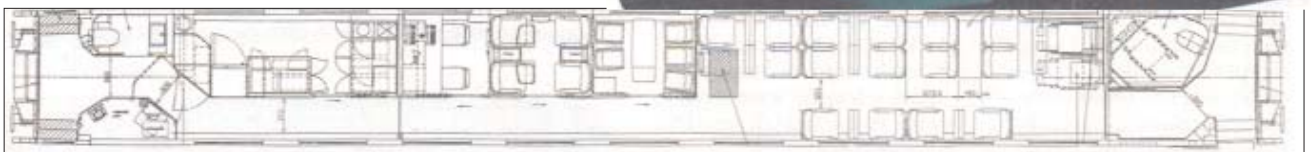
▲ Particolare della carrozza Bar-ristorante .
