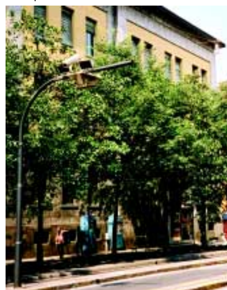
Particolare del sistema Rita per il controllo delle corsie preferenziali
