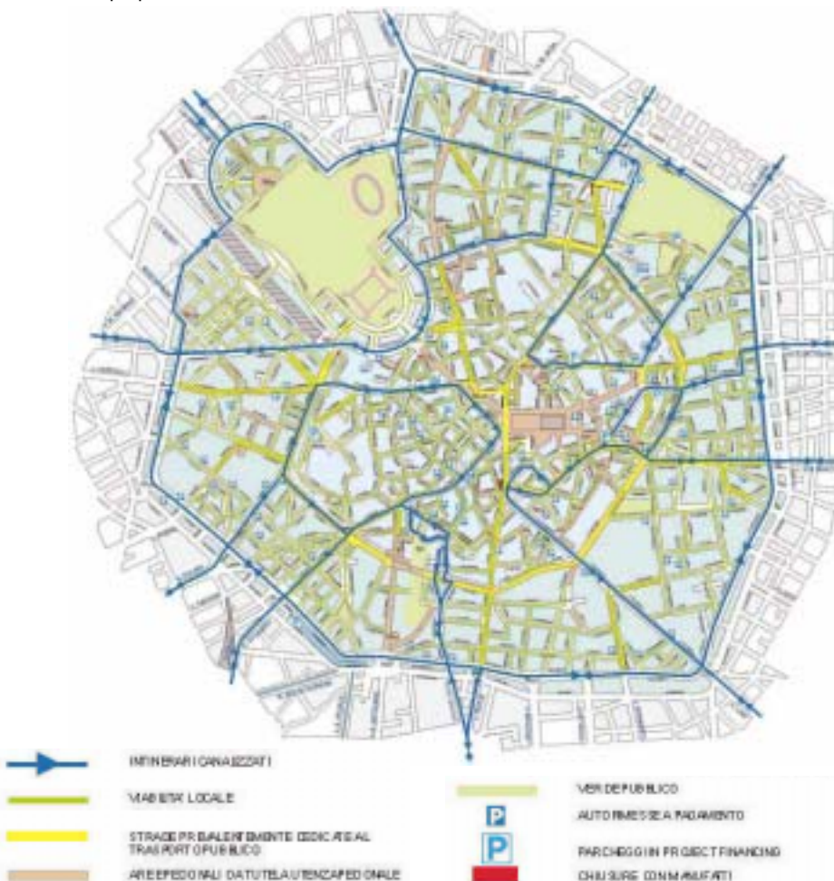
Pianta della proposta di circolazione canalizzata all'interno dell'area dei Bastioni, a Milano
