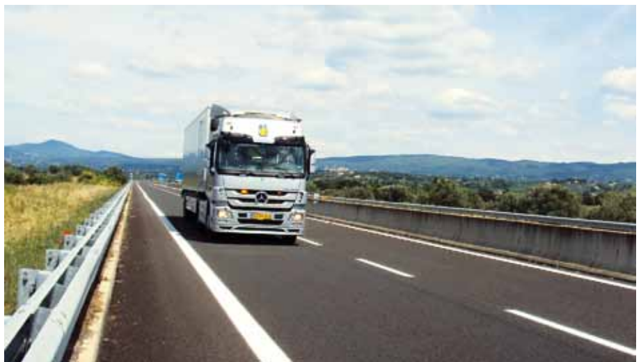
Il Tsd Anas durante un rilievo su strada
