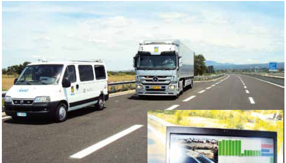
Un'altra immagine del Tsd Anas durante un rilievo su strada e particolare del suo pannello di controllo
