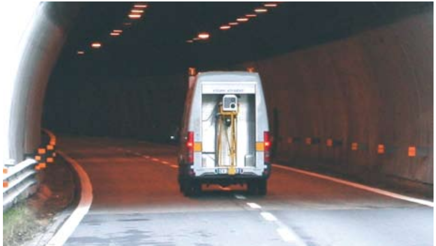
Veicolo dotato di laser scanner per il controllo delle gallerie
