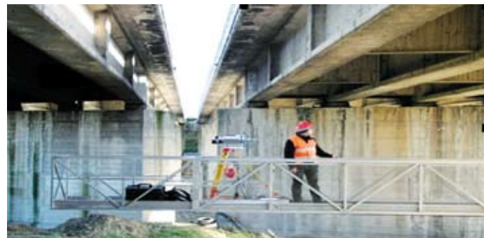
Rilievo sperimentale di un ponte con laser scanner montato su by-bridge
