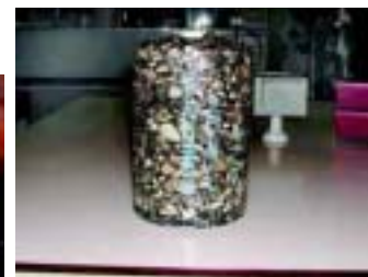
Carotaggi di uno dei tratti eseguiti con riciclaggio con emulsione, qui ricoperti solo da 2 centimetri di microtappeto, su uno spessore di 23 centimetri del materiale riciclato
