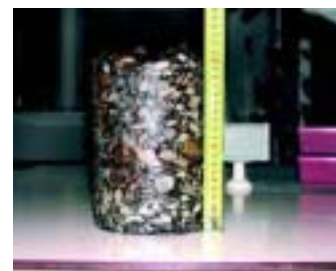
Carotaggi di uno dei tratti eseguiti con riciclaggio con emulsione, qui ricoperti solo da 2 centimetri di microtappeto, su uno spessore di 23 centimetri del materiale riciclato
