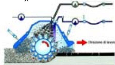
Schema della camera di fresatura e miscelazione di una Wirtgen WR 2500
