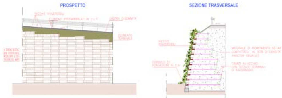
Prospetto, sezione e veduta dei paramenti dei rilevati dei ponti realizzati con elementi in calcestruzzo rinverdibili
