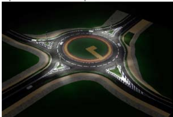
Simulazione dei risultati di una illuminazione a led delle rotatorie e particolare di uno dei lampioni
